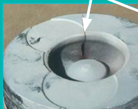
Crack initiation site
